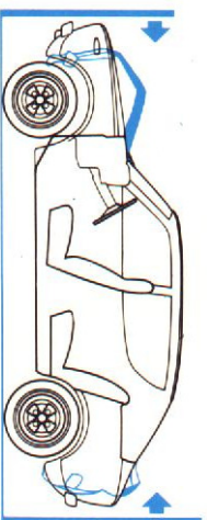
Optimale innere Sicherheit durch vorprogrammierte Krautschonzonen und 0,8 mm dickes Stahlblech
