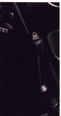
Schalthebel zum Ein- und Ausschalten des Scheinwerfer- und Abblendlichts.
